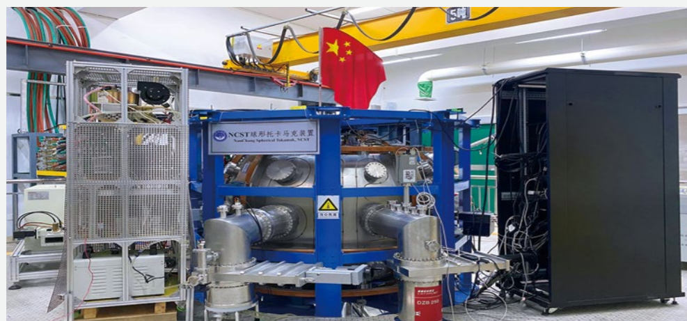
▲ 研发出我国首个可实现压缩融合启动等离子体电流的球形托卡马克装置，已正式投入运行并实现首次成功放电
